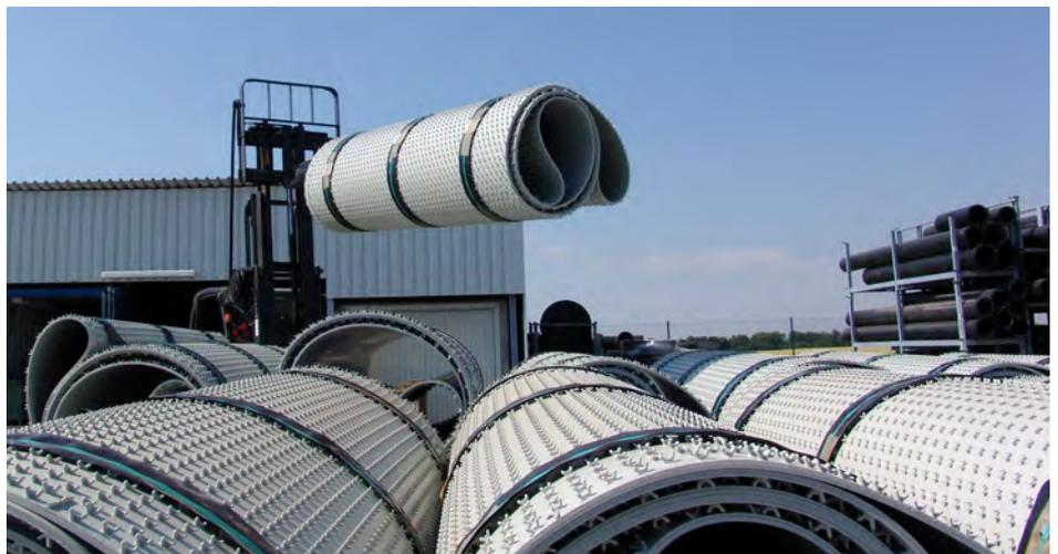
Werkseitig vorgefertigte Liner für Stahlbetonvortriebsrohre
